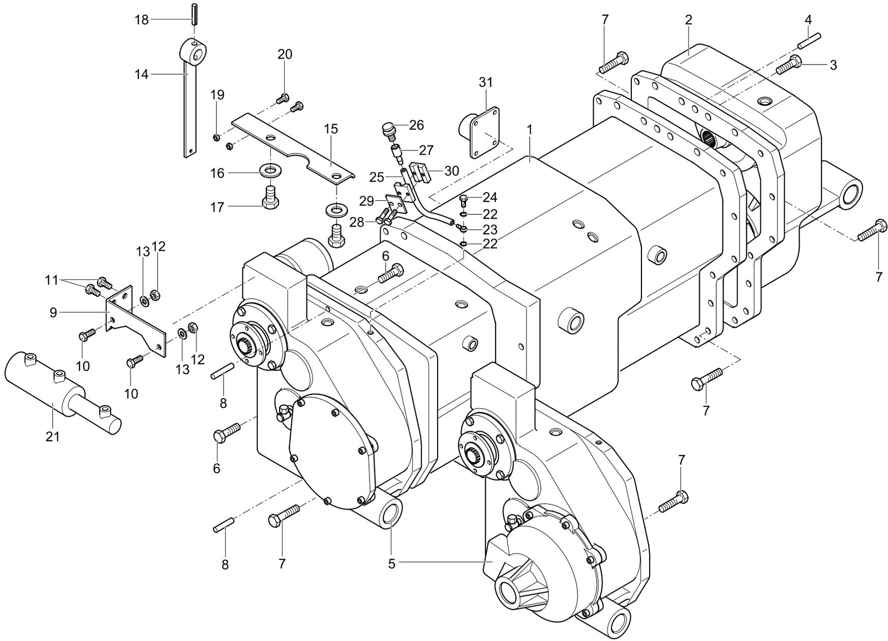
**13200****Schaltgetriebe mit Vorsatz- und Splitgetriebe**
