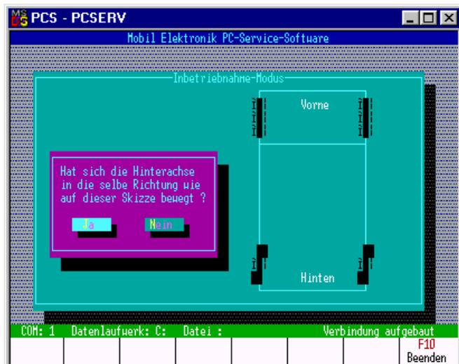
Wenn die Drehrichtung stimmt und die Abfrage mit 'Ja' beantwortet wird, folgt der 0°-Abgleich der Hinterachse. Wenn eine Verriegelungseinheit vorhanden ist muß dazu die Achse verriegelt werden, hierfür wird eine entsprechende Meldung erzeugt.
