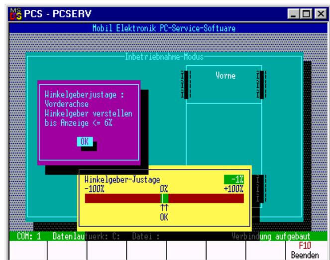
Im nächsten Schritt werden der Links- und Rechts-Abgleich durchgeführt, dazu erscheint die Anzeige entsprechend folgender Abbildung. In diesem Schritt muß die Achse auf den maximalen Winkel Links gestellt werden. Nach Quittierung der Aufforderung wird der Links-Abgleich durchgeführt.
