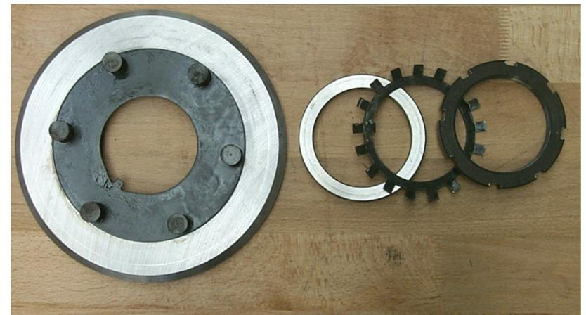
Druckscheibe, Distanzring, Nutmutter, Sicherung
