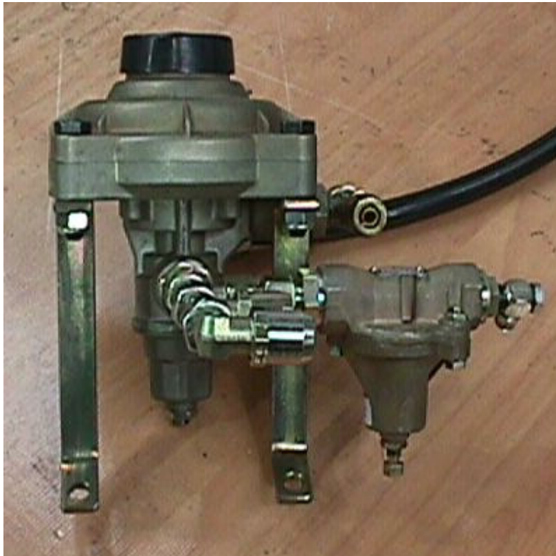
Anhängersteuerventil mit einstellbarer Drossel für Einkreisbremsanlage
